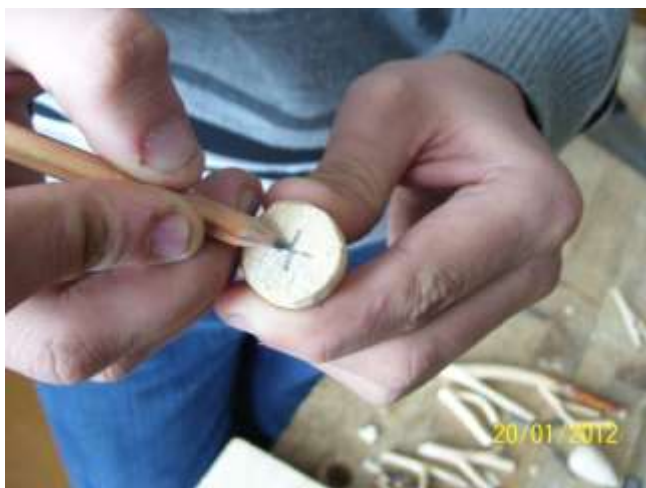
4. Размечаем центр отверстия.
